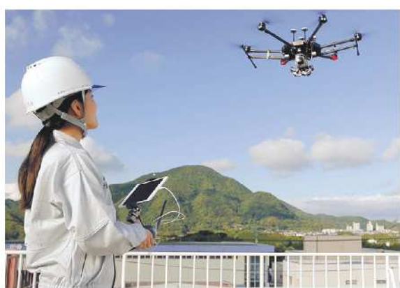
レーザースキャナを搭載したドローン
